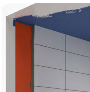
BILD M – Tak målat före platsättning
