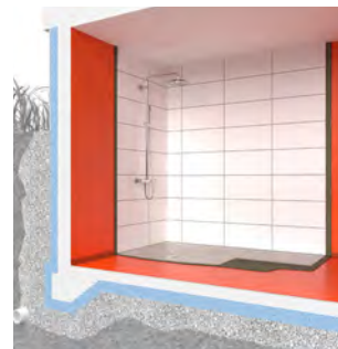
BILD B – Källare utan tillskjutande markfukt
