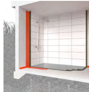
BILD A – Källare med tillskjutande markfukt
