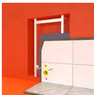
BILD P – Tätskikt bakom inbyggd WC i vägg
