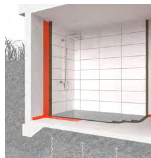
BILD A – Källare med tillskjutande markfukt
