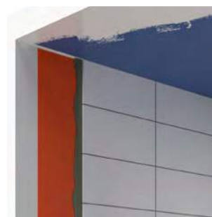
BILD N – Tak målat efter platsättning
